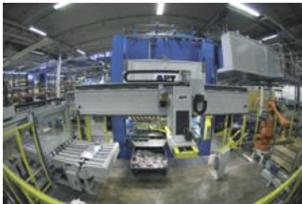
Täisautomaatliin metallplaatide stantsimiseks ja painutamiseks.
