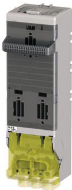
SLD 2 Jadavinnaklüliti. • AC-23B vastab IEC 60947-3 • 12 moodulit või 150 mm lai • Sular NH 2 • Võimalus paigaldada paralleellülituskäepide
