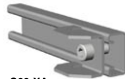
C60-XA Täiendav ankrulatt, mida saab paigaldada sokliosa sisse. Kasutatakse kapi vahetusel kui kaablit on vaja jätkata ja jätkukoht ankurdata.
