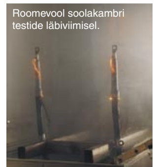
Ülelöökk kaabli otsamuhvi läbilöögi testimisel.
