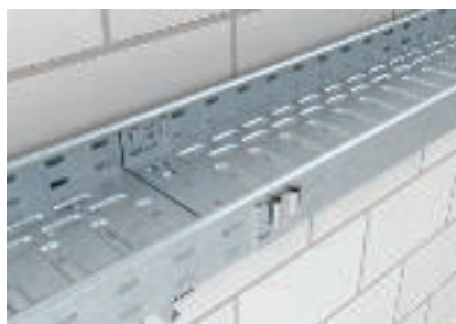
Kokkupistetav pökkühendus, ainult põhja-aasad tuleb ümber painutada
