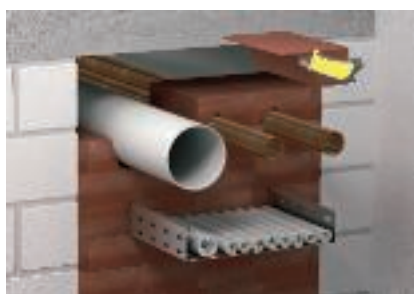
Mittepõlevate torude läbiviimine ilma lisameetmeteta
