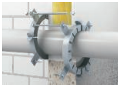
Ekstsentriline paigutus max 3 astet suuremate torumansettidega
