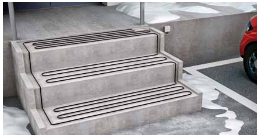
Tash püsitakistuskaabel paigaldatakse alati ahelana ning kaabli lõpp tuuakse kaabli alguse juurde tagasi. (PILT ON ILLUSTRATIIVNE)
