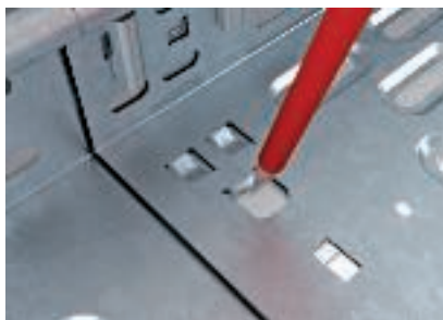
Kruvivaba pökkühendus, vajalik ainult põhja-aasade ümberpainutamine
