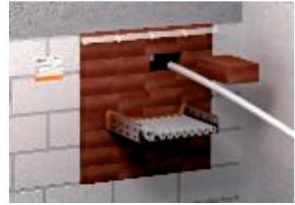
Lihtsad järelpaigaldused üksikute plokkide väljatõmbamise teel
